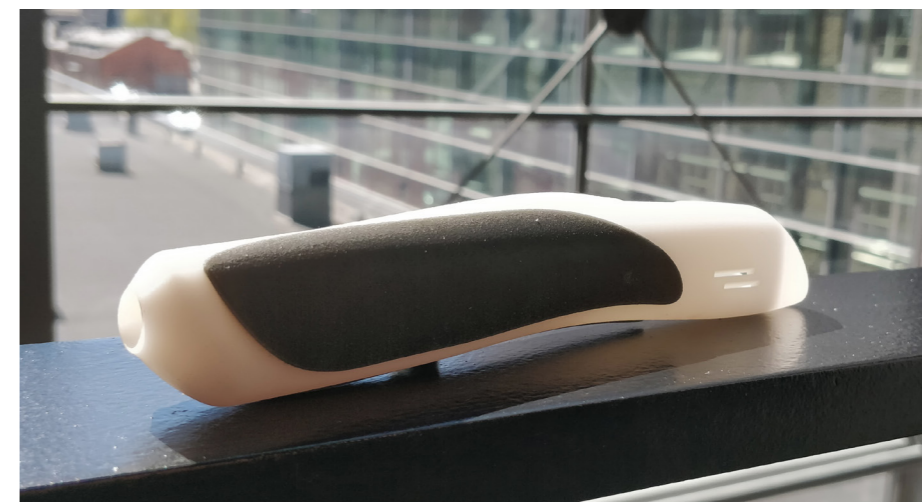
Lopullinen 3D tuloste onnistui erittäin hyvin. Valkoinen on ABS muovia fyysisiltä ominaisuuksiltaan imitoiva fotopolymeeri ja musta elastomeeria esim TPU:ta muistuttava. Tuote tulostettiin MJP multijetprinting tekniikalla.
