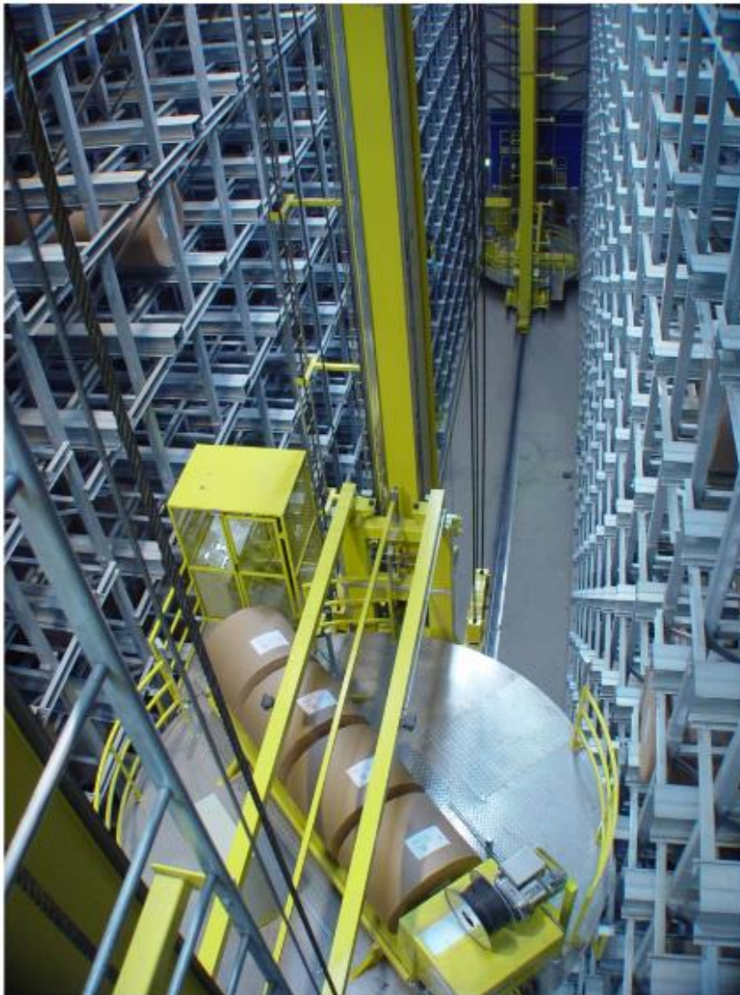
Kuva 5. Syväkanavajärjestelmän hissi (Fahllund 2012, 5).
