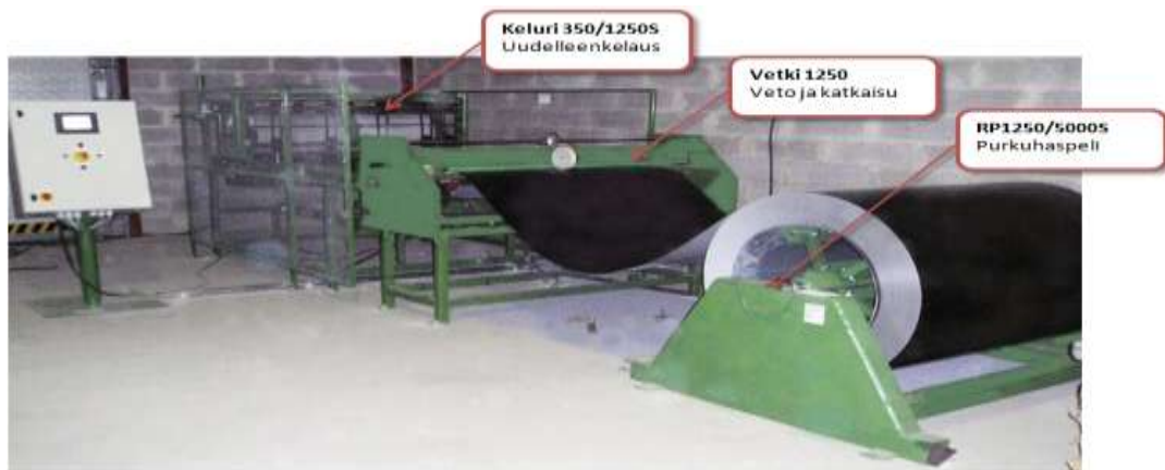
KUVIO 4. Uudelleenkelauslaite (SS-Työstö.)
