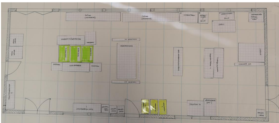
Kuva 4. Vanha layout. Työpisteiden, romulaatikoiden ja työkoneiden sijoittelu aiheutti hukkaa useassa eri muodossa
