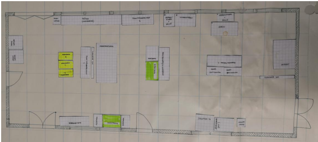
Kuva 5. Uusi layout, joka mahdollistaa suoraviivaisesti etenevän sekä selkeämmän siirtymisen työvaiheiden välillä
