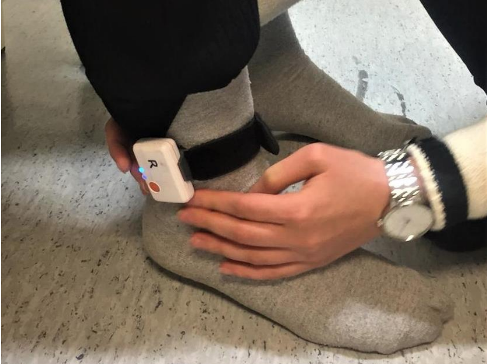
KUVIO 5. Walking Monitoring -kävelyanalyysilaitteen anturi
