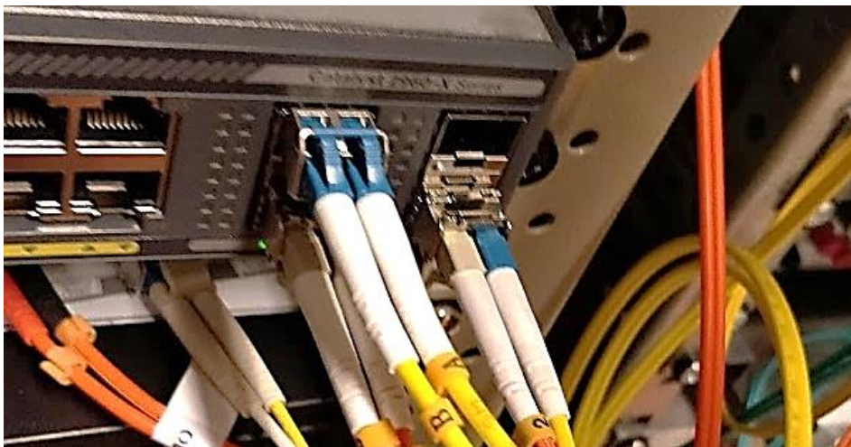
Kuva 15. LC-liittimillä varustettuja SFP-moduuleita kytkettynä Ciscon kytkimen SFP-portteihin.
