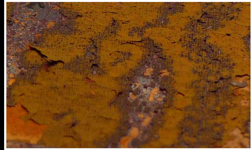
KUVA 12. Oranssikuva 600 °C, 4 minuuttia
