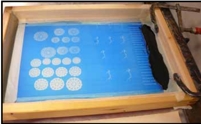
KUVA 11. Laita väriseosta seulan yläosaan
