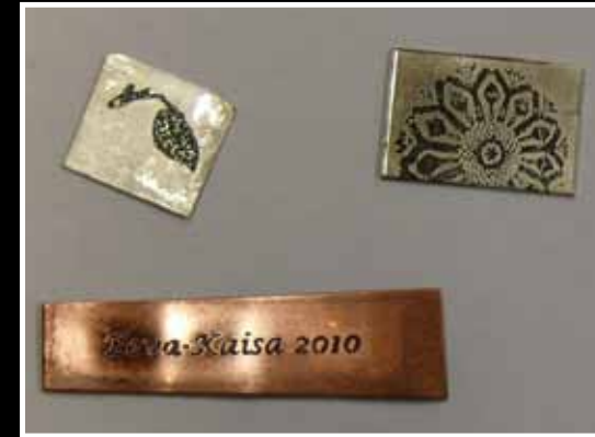
KUVA 37. Huonosti kiinnittyneet kuvat ennen kiillotusta
