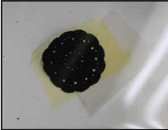
KUVA 15. Siirtokuvan irtoaminen paperista
