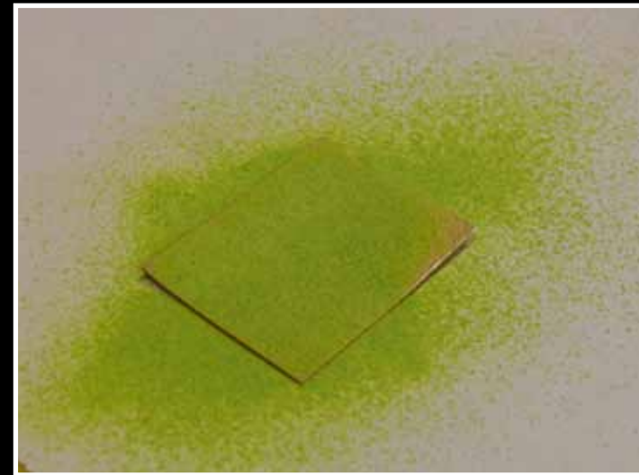
KUVA 29. Emalijauhe siirtokuvan päällä
