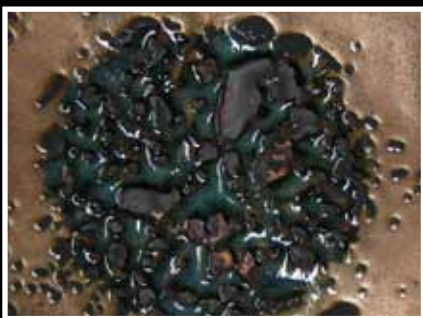
KUVA 30. Emali ja siirtokuva poltettuna samanaikaisesti
