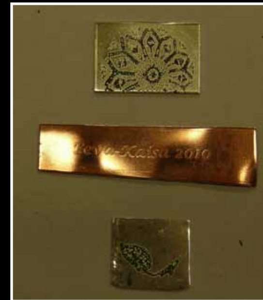
KUVA 38. Huonosti kiinnittyneet kuvat jälkeen kiillotuksen
