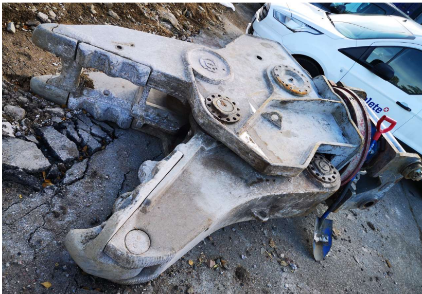
Kuva 7. Pulverointileuka betonin pulverointiin ja terästen irrotteluun (Hannele Nousiainen 2019)
