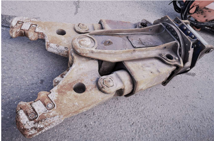
Kuva 5. Betonisaksi betonirakenteiden paloitteluun (Hannele Nousiainen 2019)
