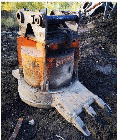
Kuva 9. Magneetti terästen erotteluun betonista (Hannele Nousiainen 2019)
