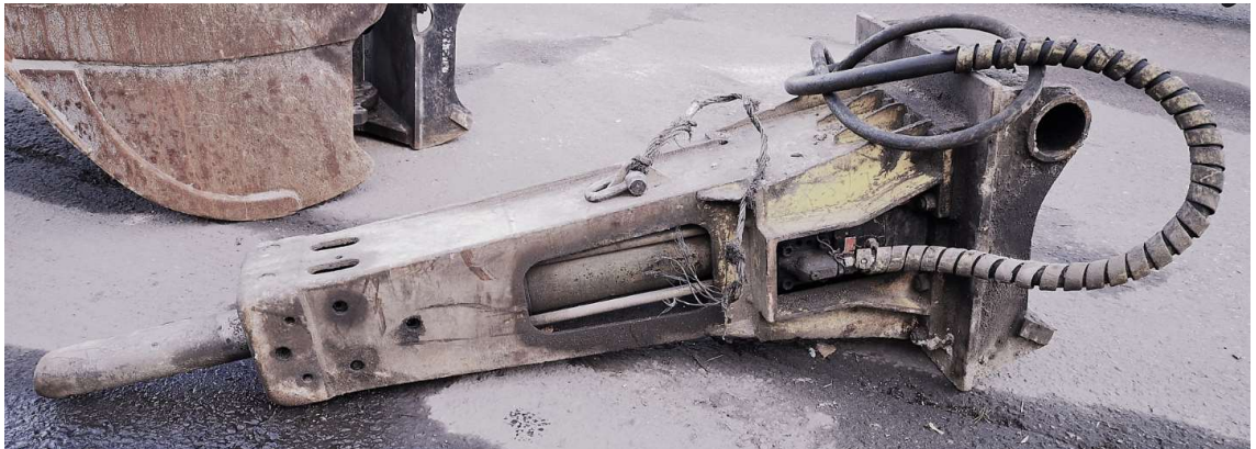
Kuva 6. Iskuvasara betonirakenteiden paloitteluun (Hannele Nousiainen 2019)
