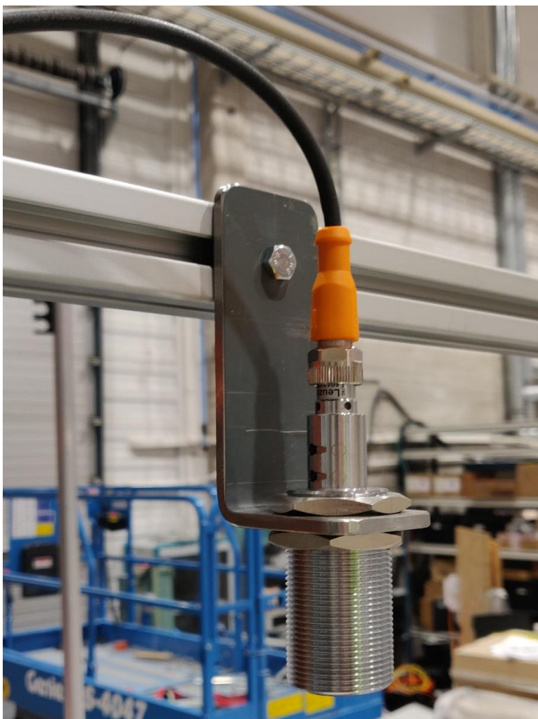
Kuva 13: M30 kokoiselle ultraäänianturille tehty pidike, alumiiniprofiili sekä Leuzen ultraäänianturi.
