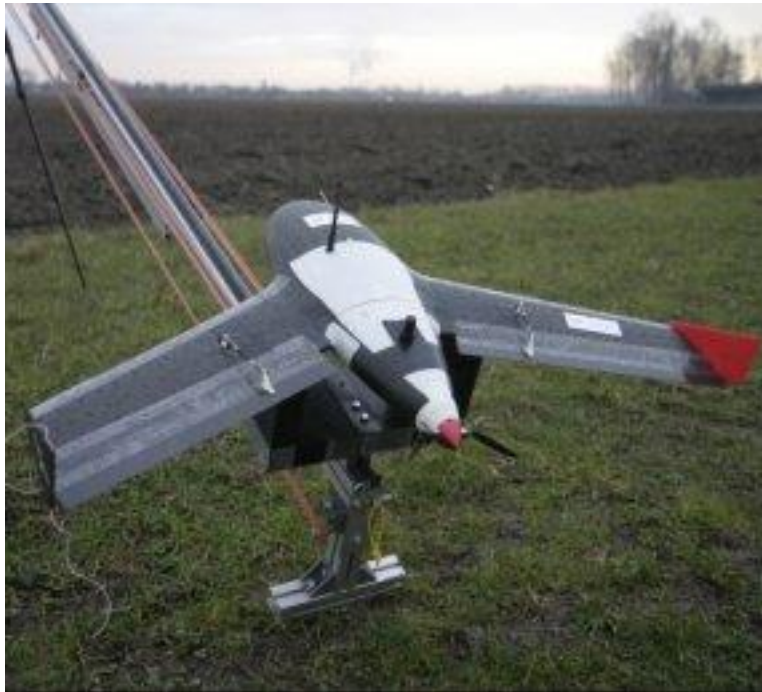
Kuvio 5. Gatewing X100 lähtövalmiina katapultin päällä. (Gatewing 2011)
