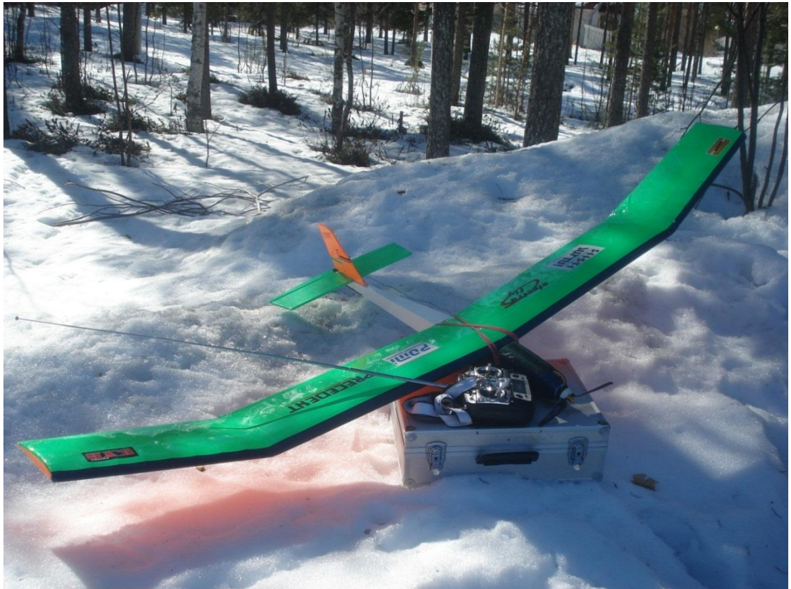
Kuvio 7. Koekuvauksissa käytetty lennokka, radio-ohjain ja tarvikesalkku.
