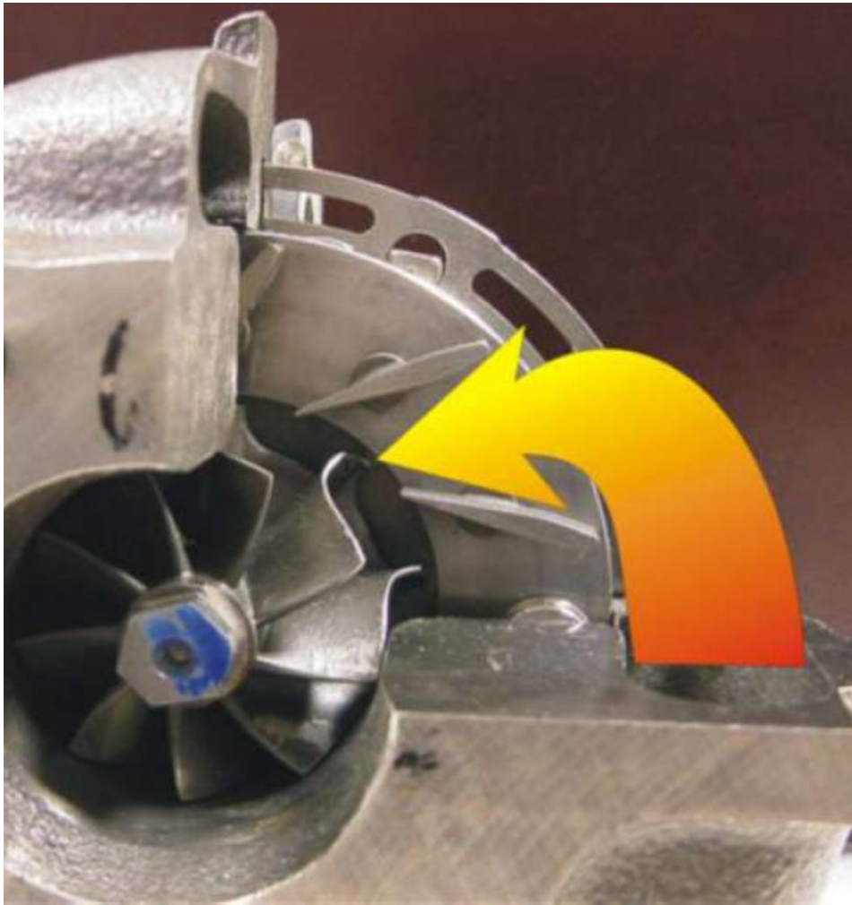
KUVIO 2. VNT-ahtimen siivet maksimivirtausasennossa (Turbotekniikka – perustietoa muuttuvageometrisista ahtimista. 2009)
