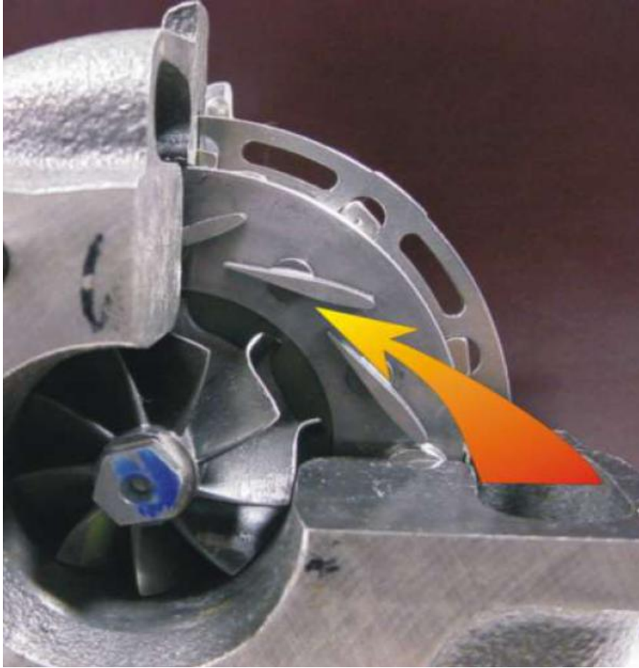
KUVIO 1. VNT-ahtimen siivet minimivirtausasennossa (Turbotekniikka – perustietoa muuttuvageometrisista ahtimista. 2009)
