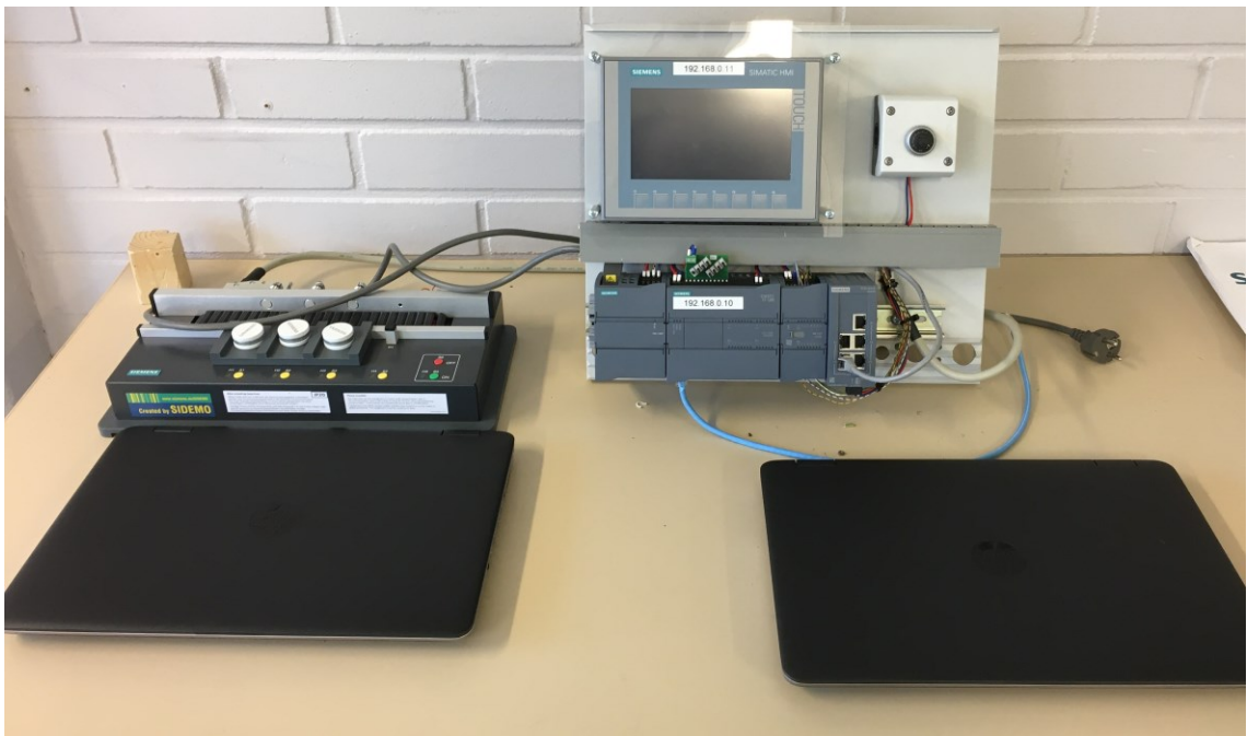
KUVA 6. Ethernet yhteyden konfigurointi- ja ohjauslaitteisto.
