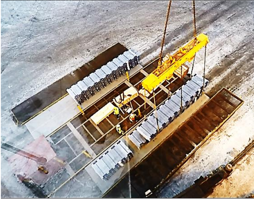
KUVA 8. Nosturia lähempänä olevat tuote- ja apualustat sijoitettuna muita alustoja edemmäs
