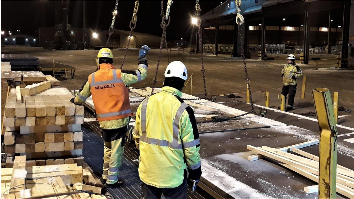
KUVA 11. Huomioliivinen kenttäturva-ahtaaja näyttää merkkiä nosturinkuljettajalle ja kaksi kenttäahtaajaa sijoittuneena turvalliselle paikalle etäämmäs nostosta
