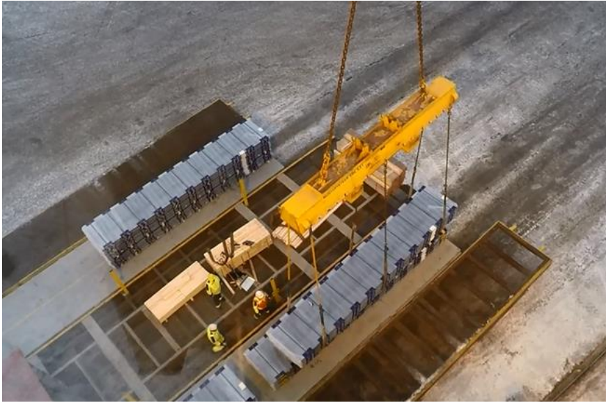
KUVA 12. Nauhalevynipun nostotilanne lastauslaiturilla, nosturinkuljettajan näkökulmasta
