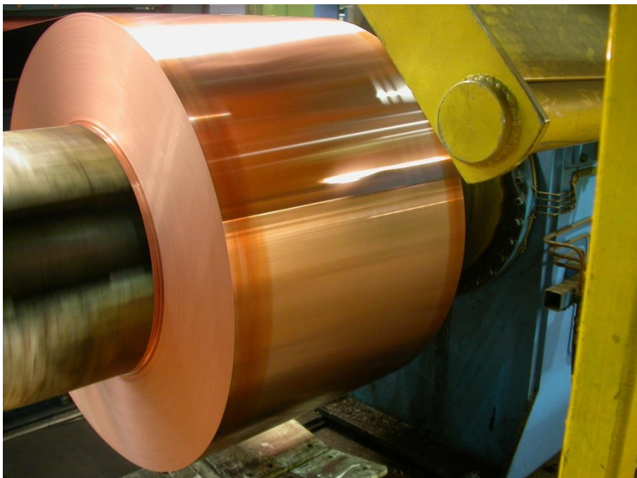
Kuva 20. Hapettuma etenee nauhan reunoilta keskelle.
