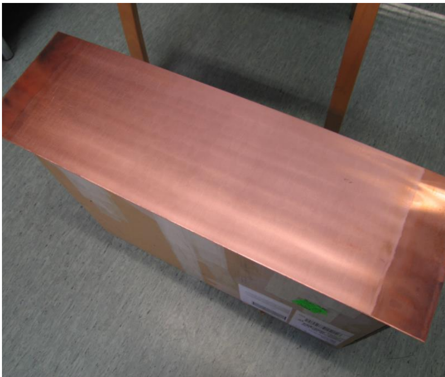
Kuva 21. Kiinnitarttuneen pinnan erottaa hyvin himmeydestä.
