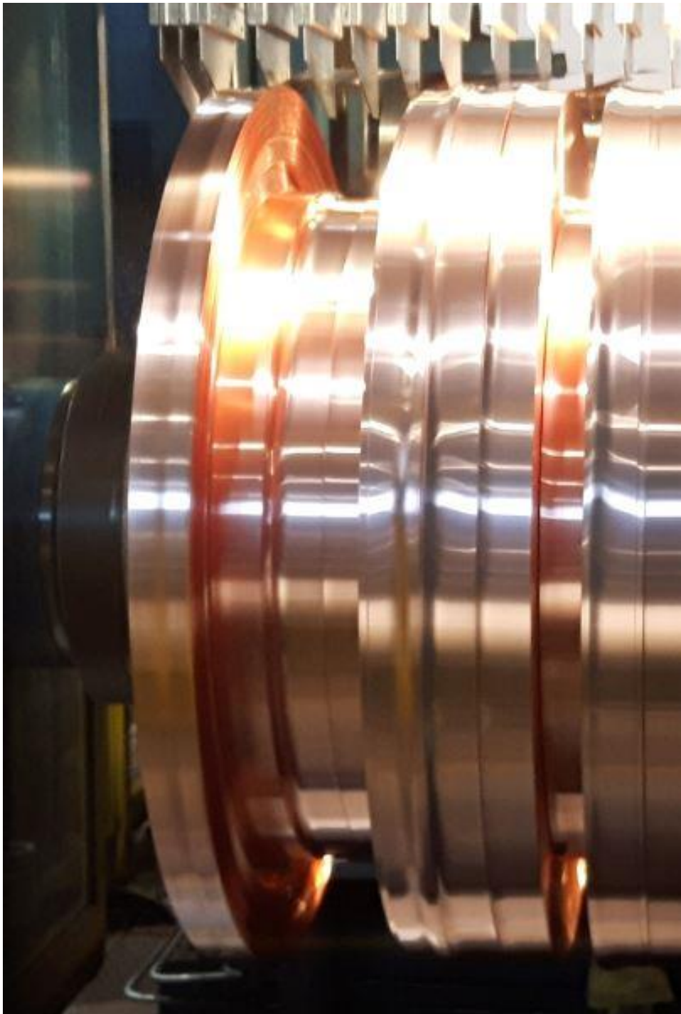
Kuva 25. Voimakas reunamous on aiheuttanut nauhojen tarttumisen toisiinsa.
