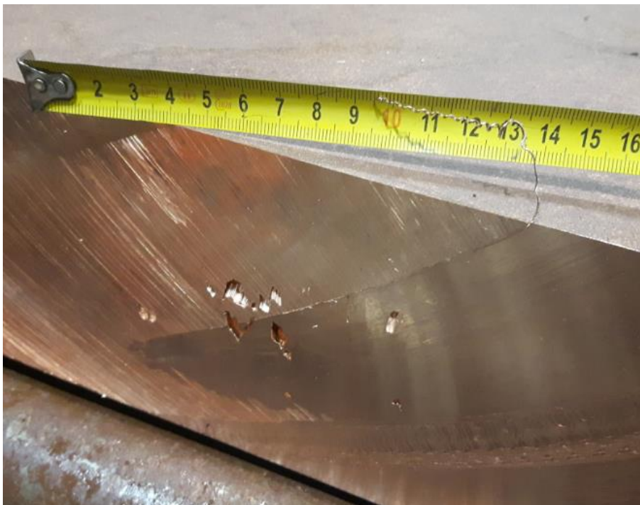
Kuva 17. Koloja ETP-laatussa (tough pitch copper, happipitoinen kupari)
