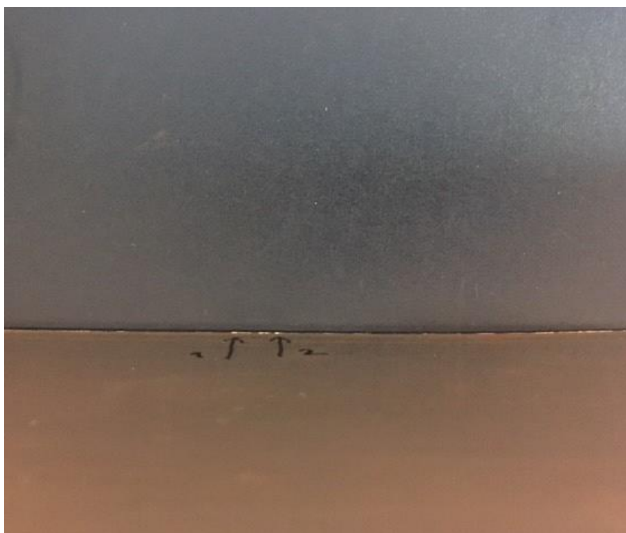
Kuva 24. Jäysteen korkeus nuolen kohdassa yli 100 \mu\text{m} .
