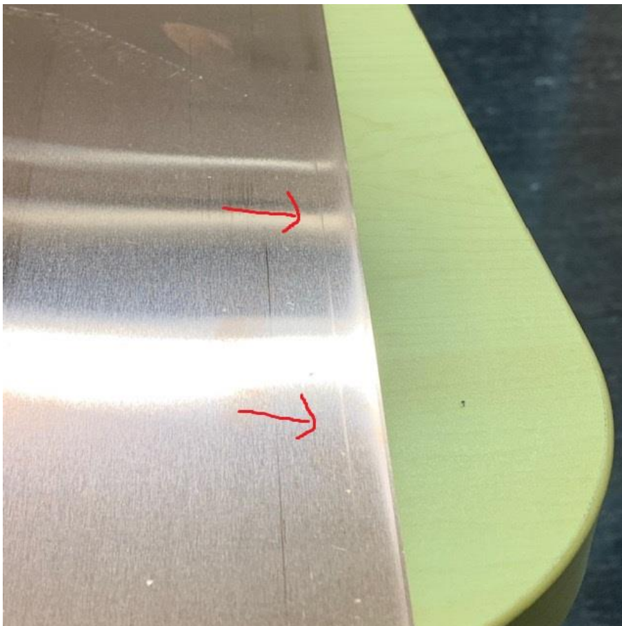
Kuva 19. Liian tiukka naaraskumi aiheuttanut nauhaan teränjäljen.
