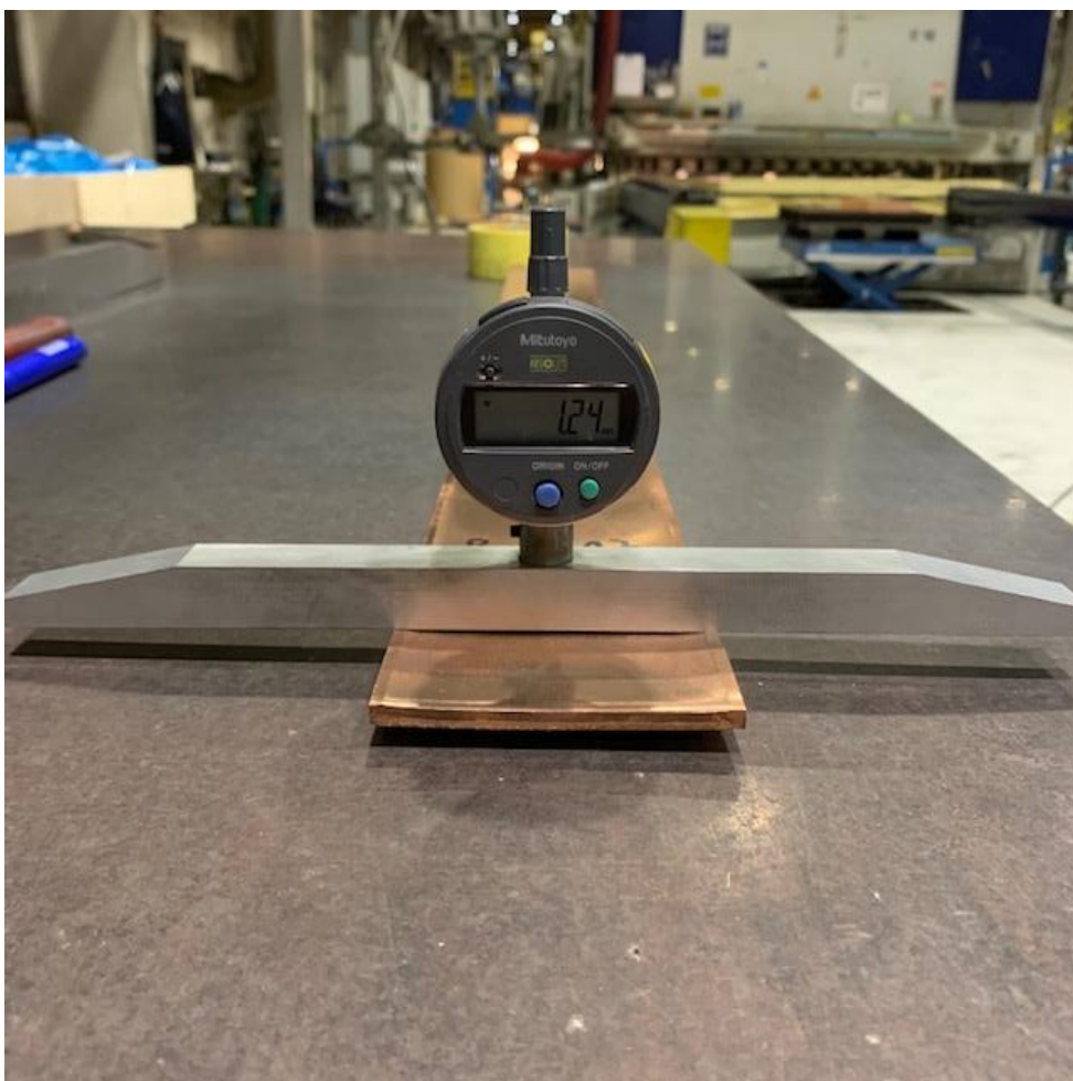
Kuva 27. Kyseisen nauhan poikittaistaipuma on 1,24 millimetriä.
