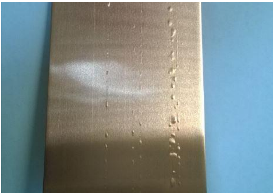
Kuva 12. Kuvan nauhassa runsaasti kuplaa.
