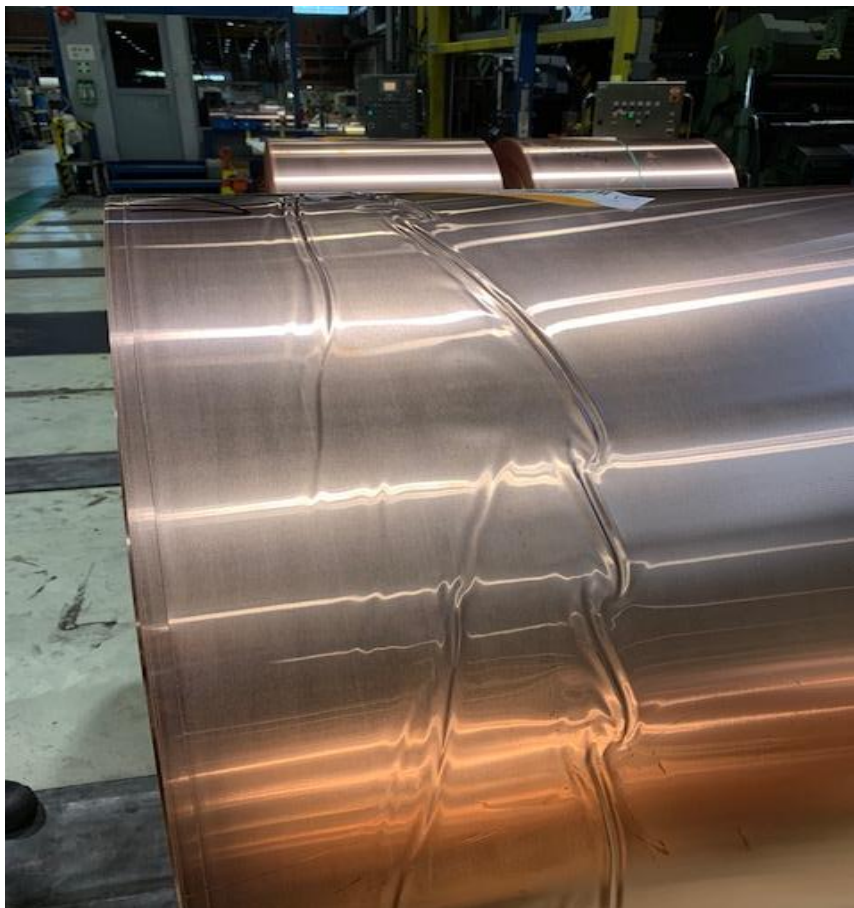
Kuva 22. Rypyt ovat etenkin ohuiden tuotteiden ongelma.
