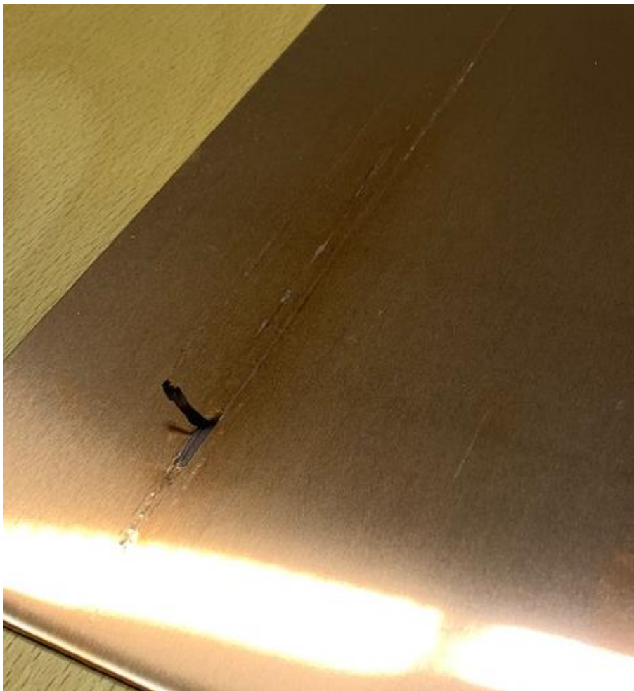
Kuva 8. Tavanomainen hilse. Pinta irtoaa lastuna.
