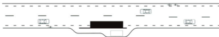
Figur 5.1-12 Utformning av körbanehållplats i landsbygdsmiljö
