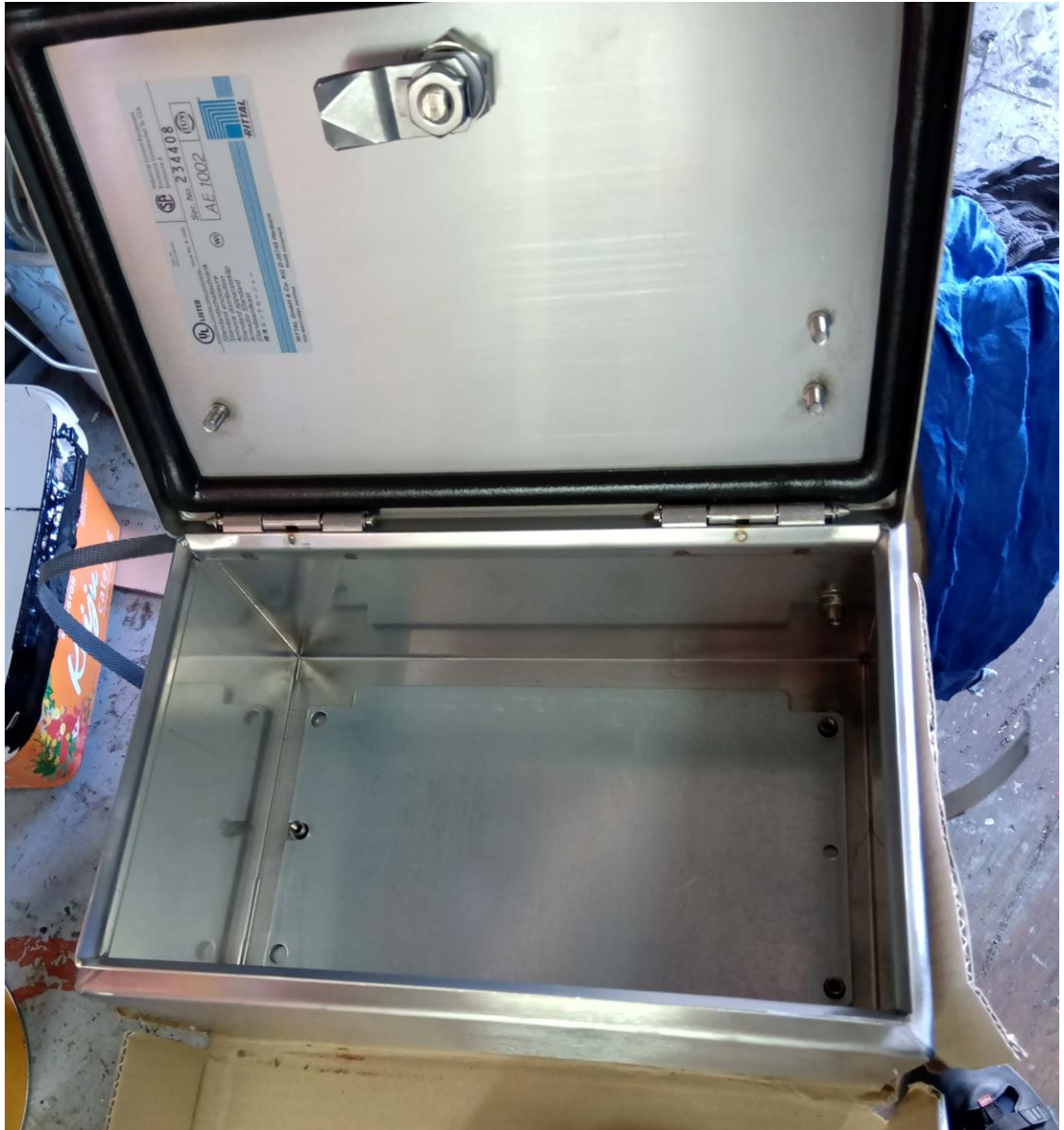
Kuva 12. Rittal-peltikaappi, systeemin magneettiventtiileiden, sysäysreleiden ja muiden sähkötekniisten komponenttien sijoituspaikka. Kuva: Harju 2019.
