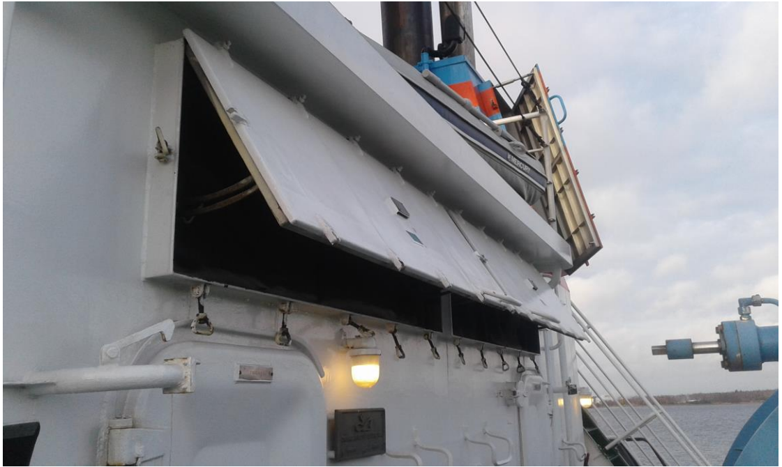
Kuva 3. Castorin kansirakennelman takaosa. Etualalla näkyvät kaksi ilmanottoluukkuja. Taustalla näkyy SB-puolen korsteeniluukku, josta ilma poistuu. Kuva: Harju 2019.
