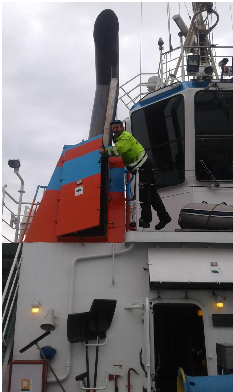
Kuva 19. Luukkujen manuaalista operointia. Kuva: Harju 2019.
