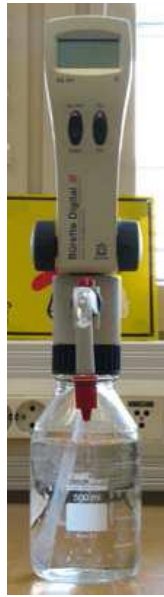
Kuva 8. Titrauksessa käytetty digitaalibyyretti, jonka tarkkuus on 0.01ml /6/
