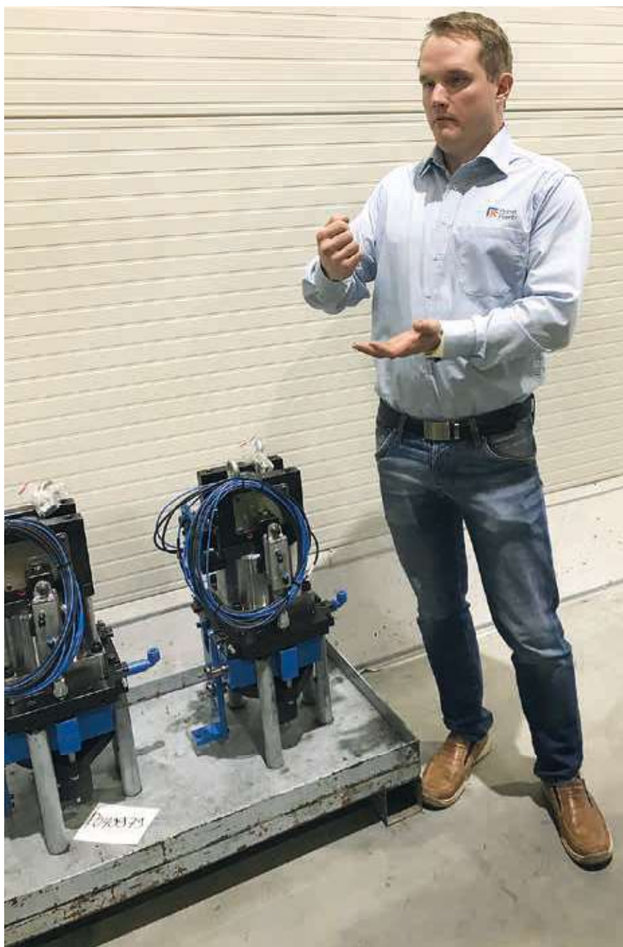
Antti Rintaniemi esittelee levytyökeskuksen sydäntä, lävistyssylinteriä
