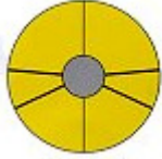
KUVA 7. FF-valonheittimen heijastajapinnan segmentit edestä katsottuna /9/
