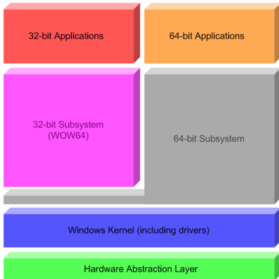
KUVA 2 Windows XP Pro x64 mahdollistaa 32-bittisten ohjelmien käytön WOW64-alijärjestelmän avulla. Arkkitehtuurin pohjalla oleva "läpinäkyvä" laitteistoemulaatiokerros ei huononna 32-bittisten ohjelmien suoritukykyä juuri lainkaan. /39/.
