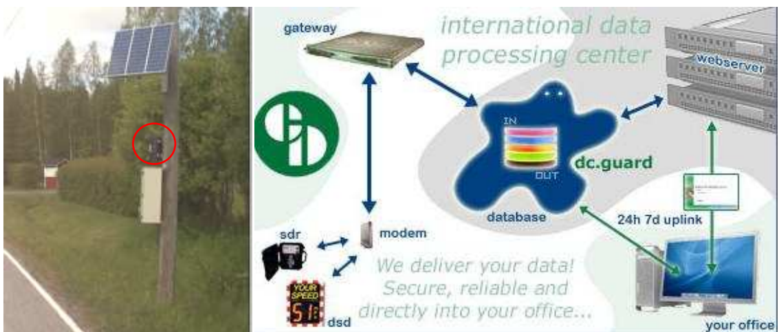
KUVA 13. Vasemmalla jatkuvatoiminen SDR-laskentalaite. Oikealla GPRS-tiedonsiirto (Trafficdata. 2011)
