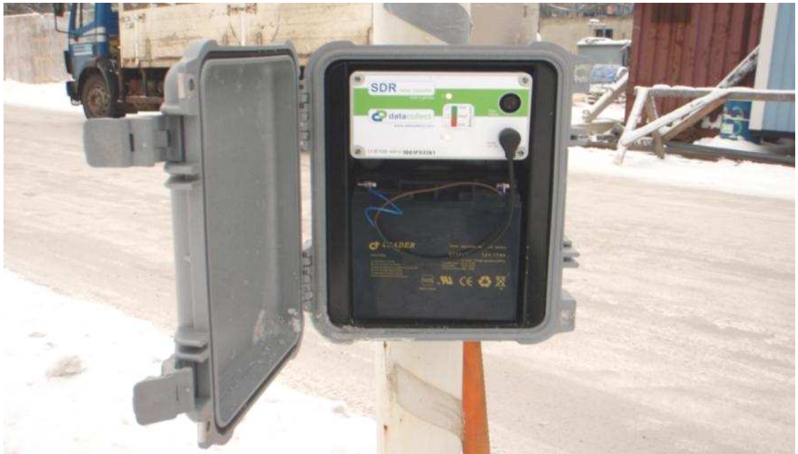
KUVA 12. SDR- mikroaaltolaskin, jonka alapuolella on 12 V:n akku
