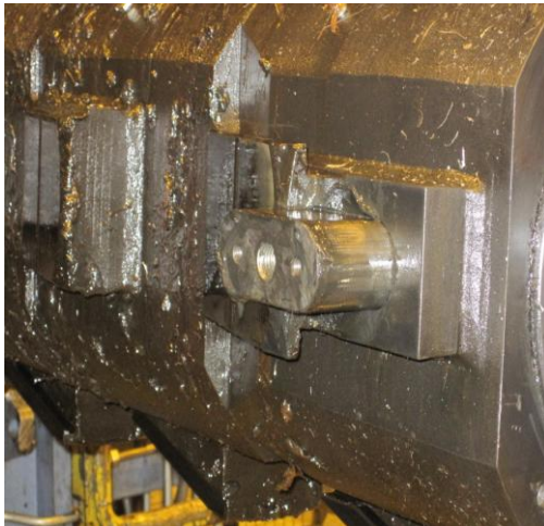
Kuva 22. Kiila osittain ulkona.
