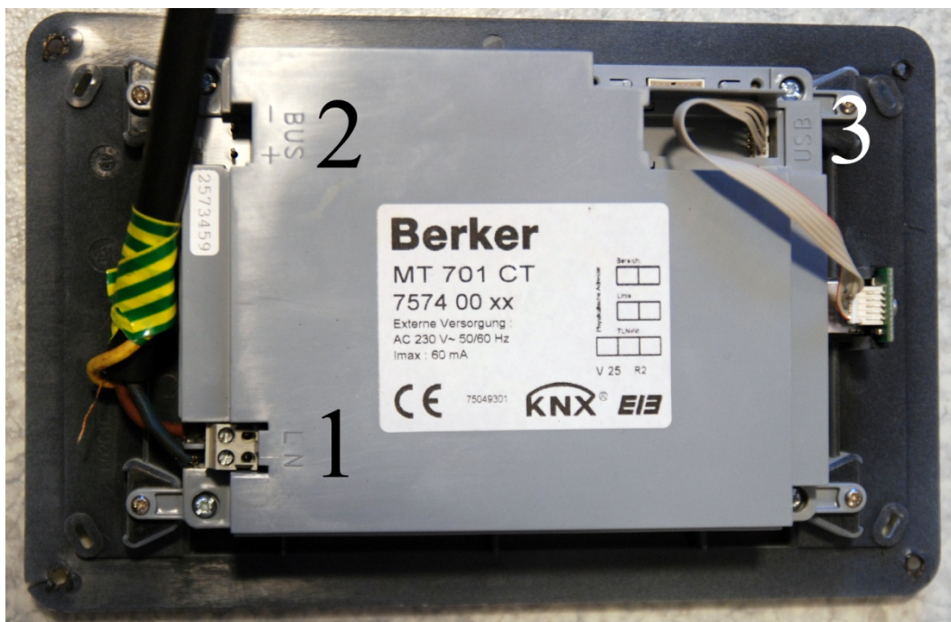
KUVIO 29. Kuviossa on Berkerin seinäpaneeli MT 701 CT pohjasta kuvattuna. Paneeli on muuten sama kuin Master Control mutta ilman RJ45-liitintä
