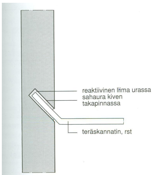
Kuva 17: Urakiinnityksen periaate [7, s. 74]
