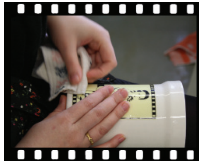
Kuva 68. Siirtokuva kiinnitys valmiiseen purkkiin.
