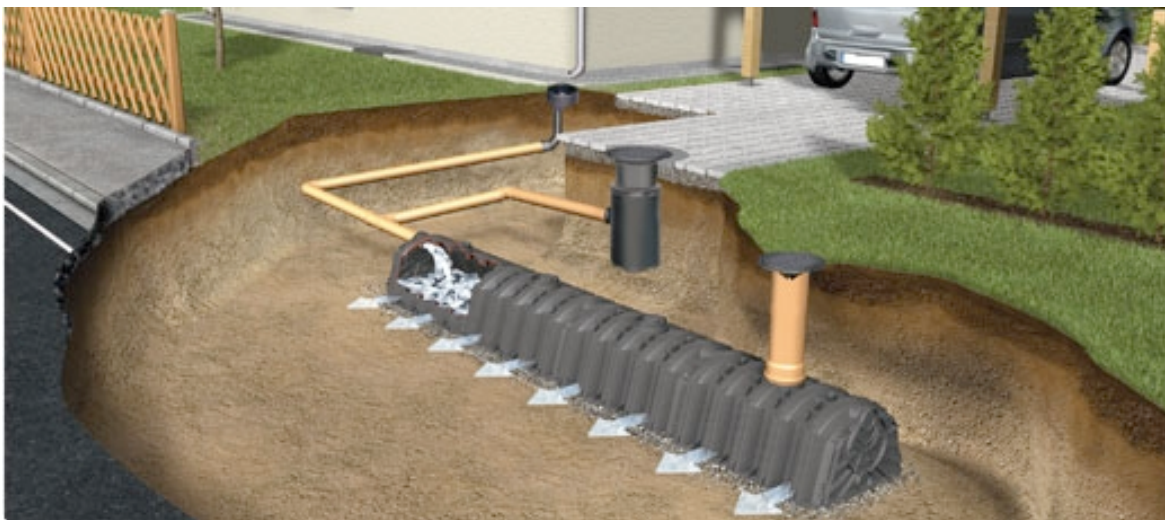
Kuva 9. Hulevesitunnelin rakenne (Uponor 2009).
