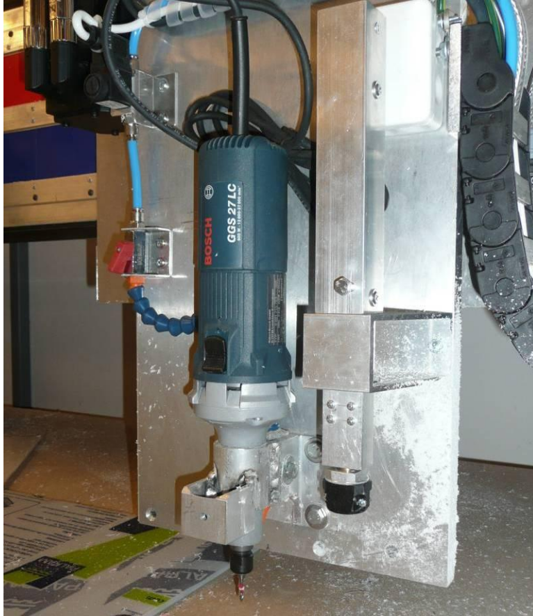
KUVIO 30. Kuvassa keskellä jyrsinkara ja oikealla teränpidin telineessään. Kuvassa näkyy myös terän jäähdyttämiseen tarkoitettu taipuisa puhallusputki.
