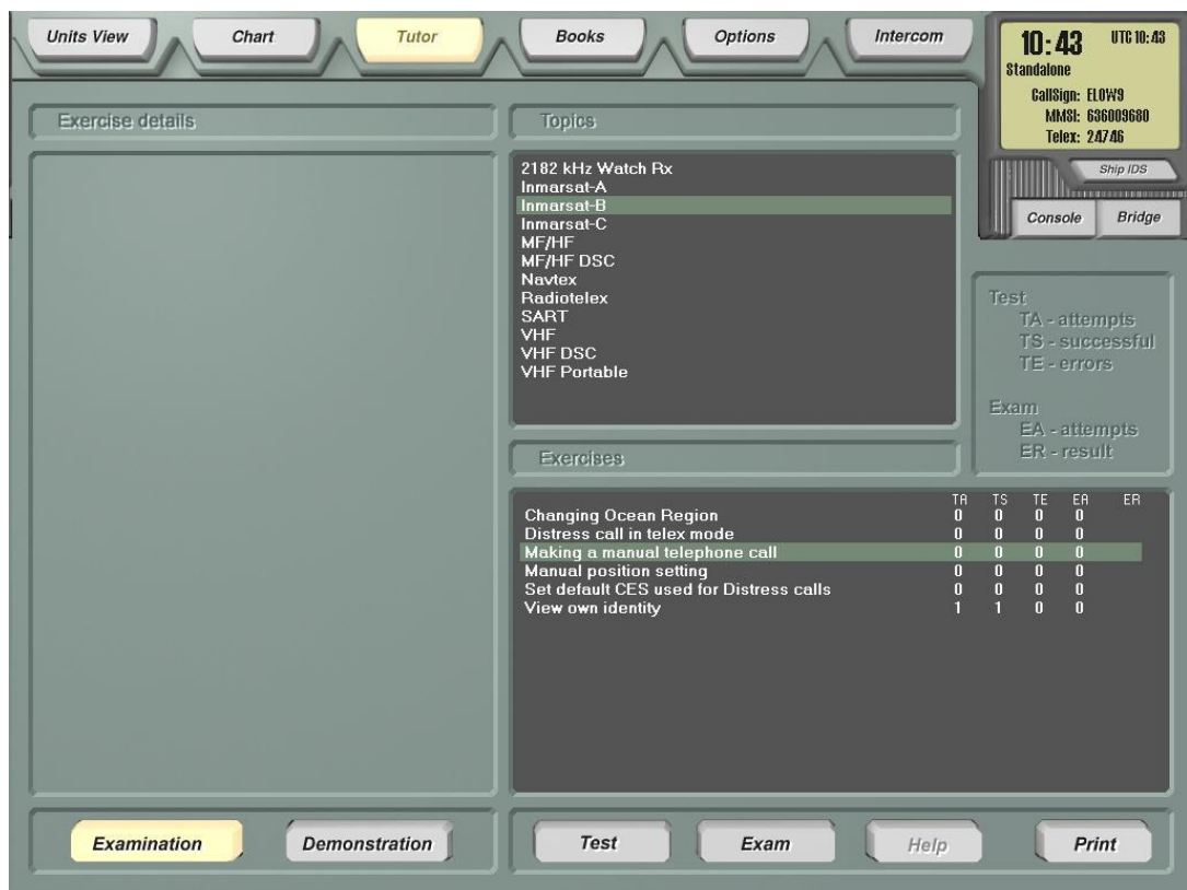
Kuva 7. TGS 4100 -simulaattorin itseopiskeluohjelma. Alavasemmalla ovat nähtävissä kontrollit tilanvaihtoon. Alaoikealla ikkunassa on kirjanpito suorituksista. (TGS 4100 Product Description, 2008, 21.)
