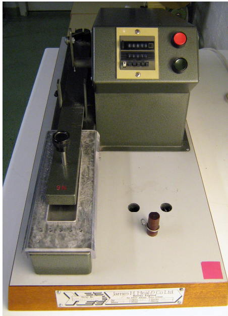
KUVIO 30. Crockmeter -hankauslaite
