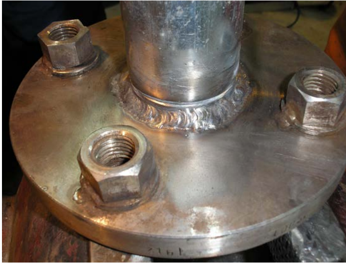
Kuva 20: RST-laippa ja putki tig-hitsattu, harjattu ja peitattu sivelemällä peittausneste suoraan saumalle.
