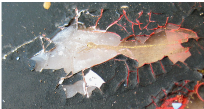
Kuva 15. Kukkakuvion irronneen maalipinnan alla lasissa vaaleana sameana alueena näkyy liimavesipohjuste (Pöri 2011).
