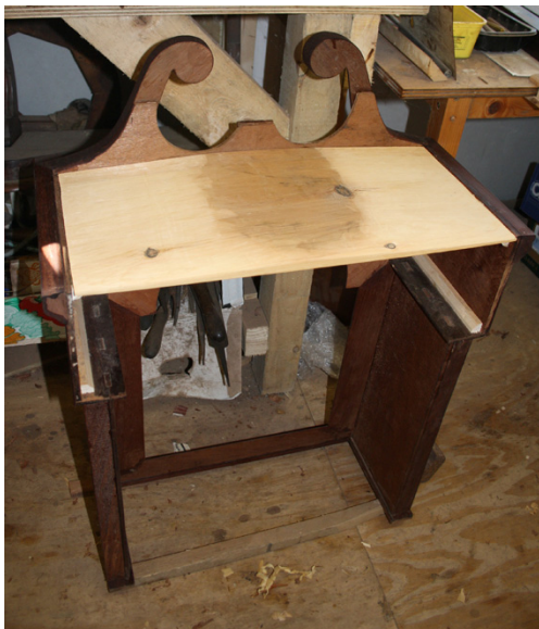
Kuva 51. Katto liimattuna paikoilleen (Salminen 2011).
