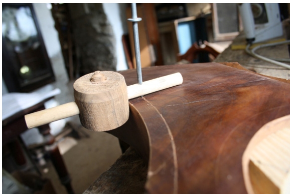
Kuva 42. Viilun leikkaus suuntapiirtimen avulla (Salminen 2011).
