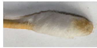
Kuva 36. Kellohuoneen liukoisuustesti asetonilla (Salminen 2011).
