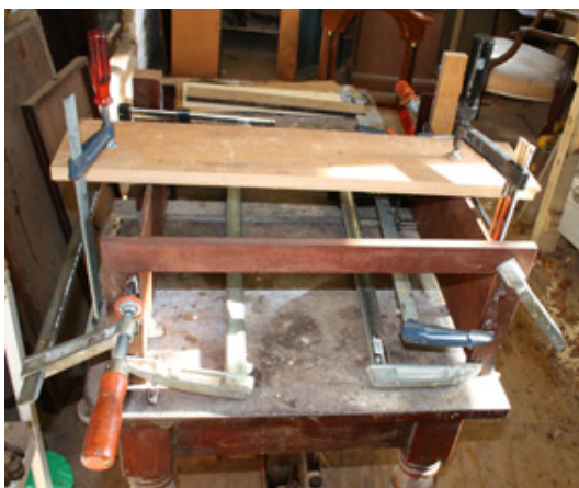
Kuva 40. Runko-osan liimaus (Salminen 2011).
