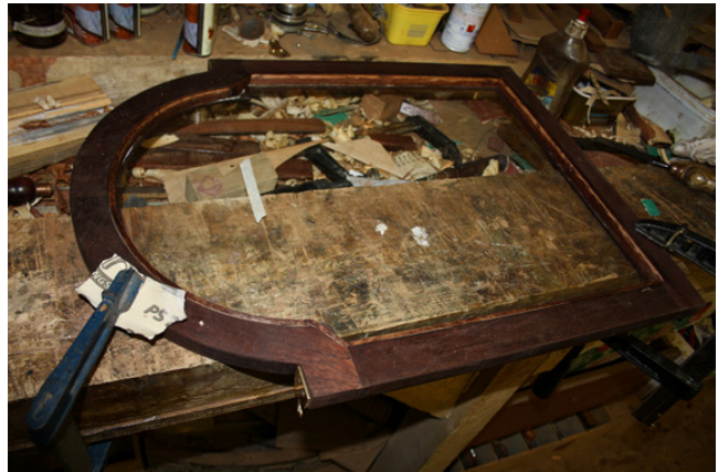
Kuva 46. Lasi kiinnitettynä oveen (Salminen 2011).
