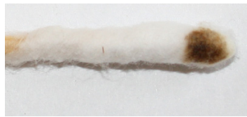
Kuva 35. Kaapin liukoisuustesti spriillä (Salminen 2011).
