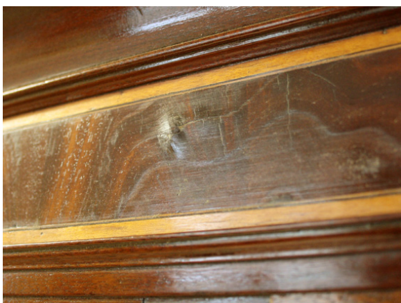
Kuva 5. Kaappiosan yläosan irtonainen viilu ennen silityksraudalla kiinnitystä (Salminen 2011).
