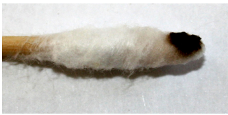
Kuva 34. Takalevyn liukoisuustesti vedellä (Salminen 2011).
