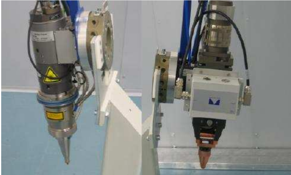
KUVA 14. Precitec prosessioptiikat: vasemmalla leikkauspää YK52 ja oikealla hitsauspää YW50 (7)
