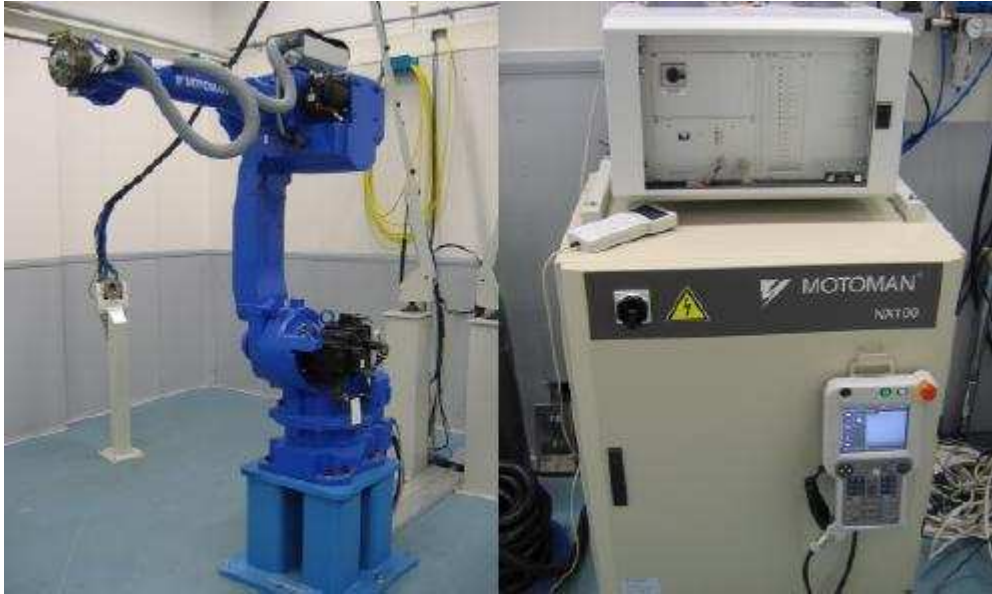
KUVA 15. Motoman UP50N -robotti ja Motoman NX100 -ohjaus (7)
