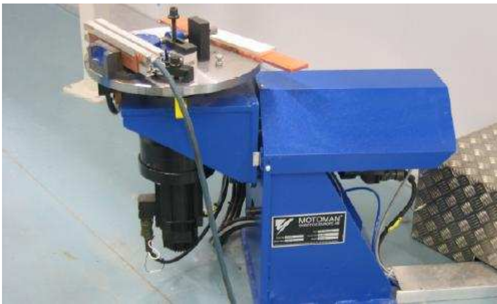
KUVA 16. Robottityöaseman Motoman MT1-250 S2CX -käsittelylaite (7)
