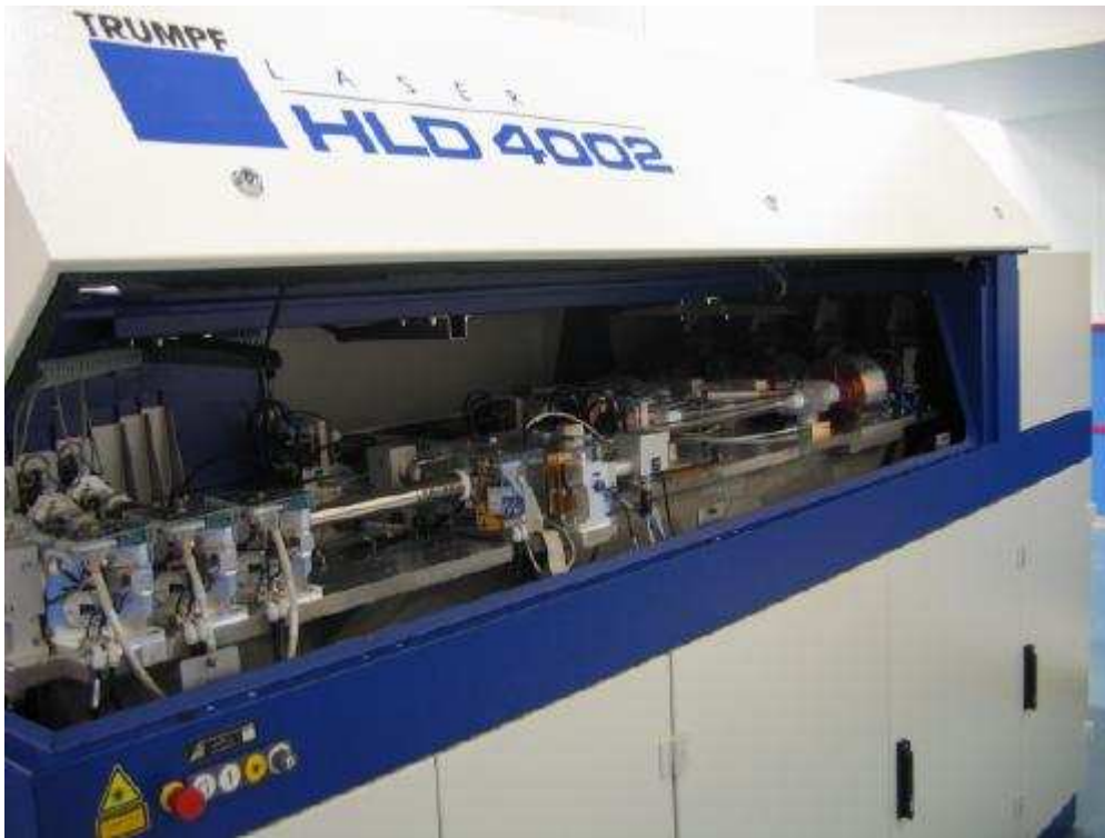
KUVA 13. Robottityöaseman laser ELME Studiolla, Trumpf HLD 4002 -kiekkolaser (7)
