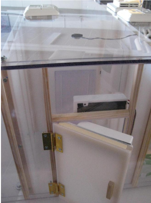
KUVA 25. Ulko-oven magneetti anturi asennettuna
