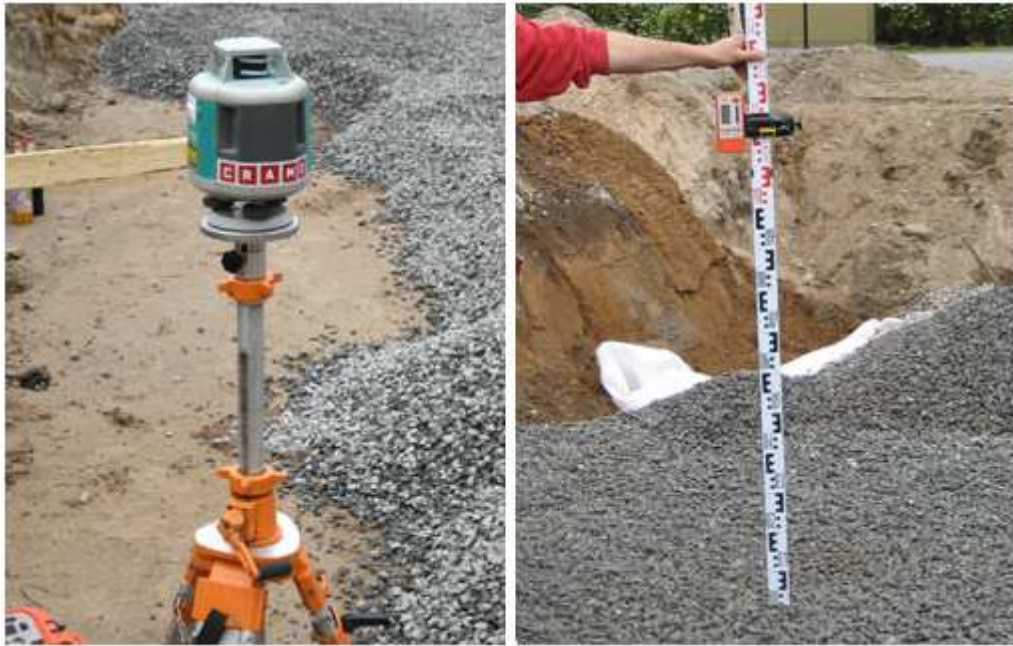
Kuvio 3. Tasolaserin lähetin vasemmalla sekä vastaanotin oikealla. (Rakentaja.fi, [Viitattu 15.3.2011].)
