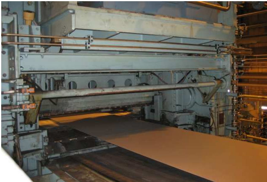
Kuva 3. Päätyleikkuri ja läpi kulkeva teräsnauha jättöpuolelta kuvattuna.
