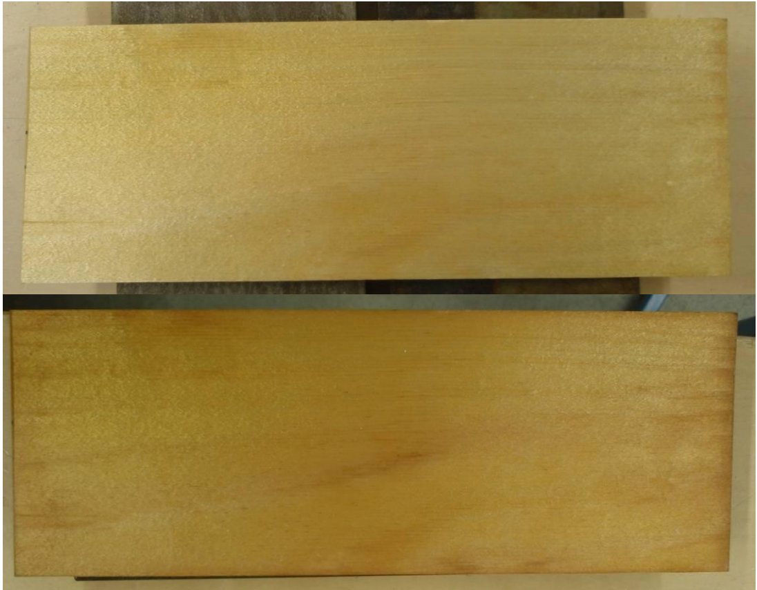
Kuva 14. Koekappaleen lape ennen ja jälkeen sääolosuhdestin. Kuva: Tomi Ryynänen
