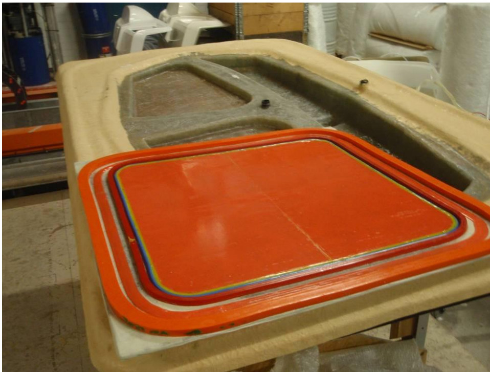
Kuva 4. Tiivisteet sekä vahalevyt päämuotinpinnalla. Kuva: Tomi Rynnänen
