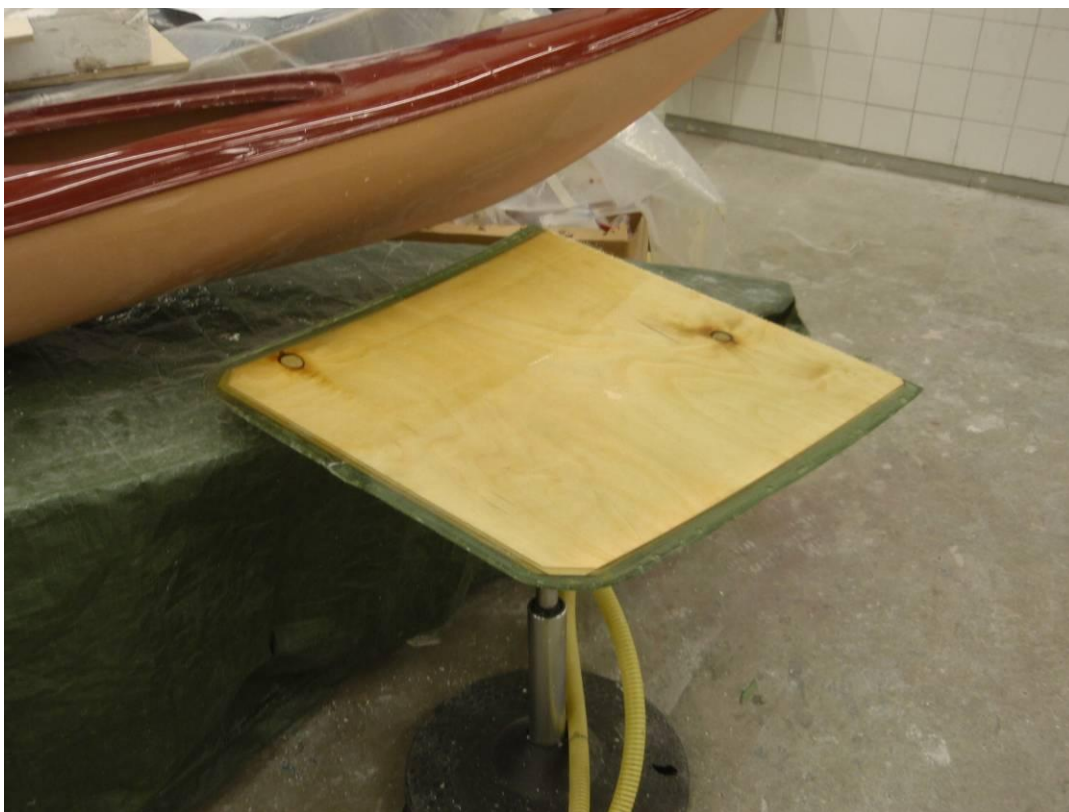
Kuva 7. Polyesterihartsilla injektoitu koekappale. Kuva: Tomi Ryynänen
