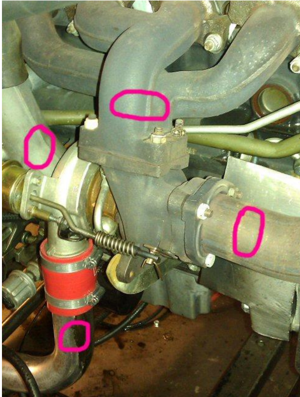
Kuvio 25. Pakokaasuahdin. Ympyröidyt paikat osoittavat antureiden kiinnityspisteitä.
