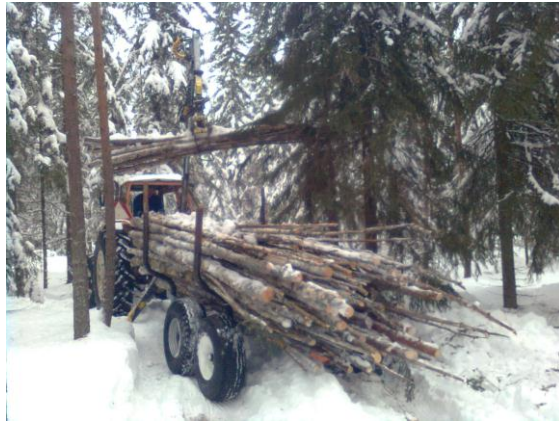
Kuvio 6. Energiapuurungot pitää katkoa sopivan pituisiksi kuormausta ja kuljetusta varten.
