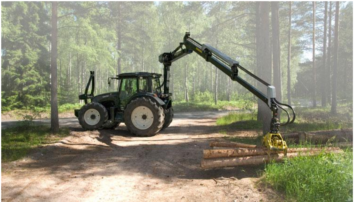
Kuvio 4. Maataloustraktori puutavara kuormajalla.
