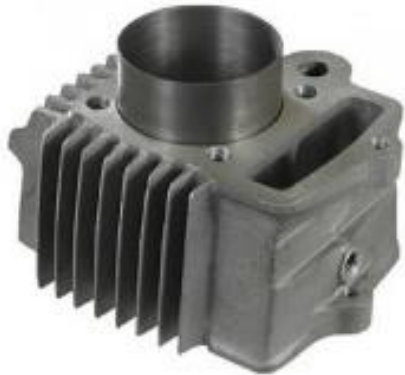
Sylinteri, joka on tieliikennekäyttöön sallittua 50 cm 3 suurempi
