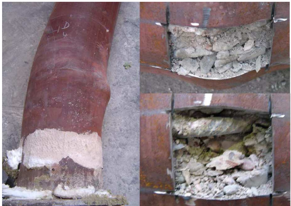
Kuva 9. Liittopilari polttokokeen jälkeen /12/
