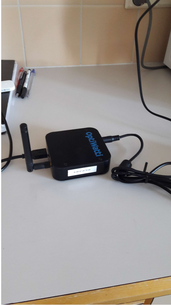
Kuva 3. OptiWatti-järjestelmän keskusyksikkö, joka muodostaa internetyhteyden.
