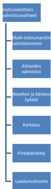
KUVIO 3. Instrumenttien valmistusvaiheet
