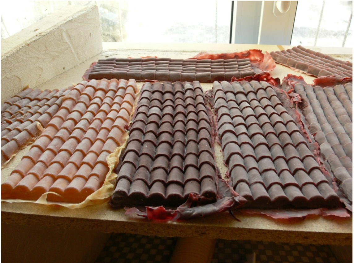
Kuva 21. Lateksista yksiosaisella kipsimuotilla valettuja kattotiililevyjä. Lateksi on värjätty etukäteen akryylimaaaleilla.
