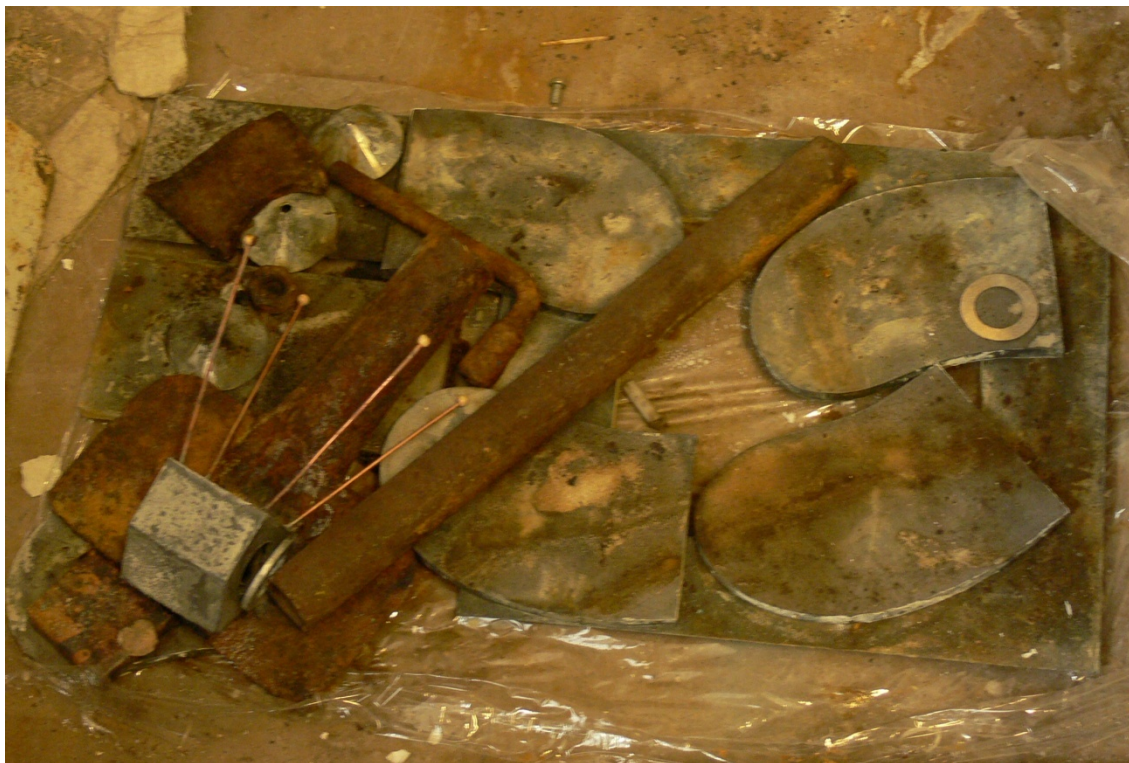
Kuva 28. Ruostutettavana olevia metalliosia. Ruoste leviää märästä esineestä toiseen ja erilaisia kulumia saadaan aikaan myös suolahapolla.
