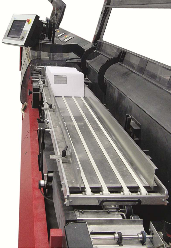
Kuva 14. Kirjekuorien kuljetus liukuhihnalla.
