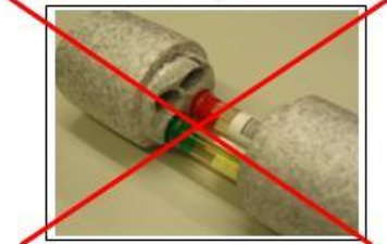
Näyte väärin putkessa, täytemateriaali puuttuu!!
