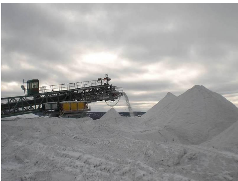
Kuva 2. Kipsi kulkeutuu kasalle liukuhihnojen avulla
