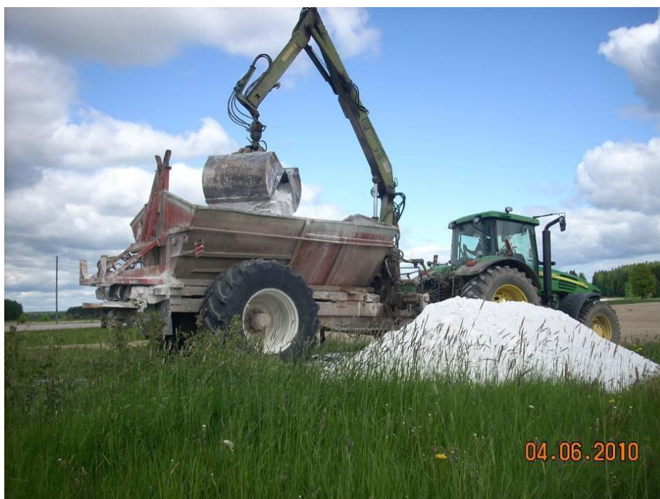
Kuva 5. Urakoitsija lastaamassa kipsiä kalkitusvaunuun
