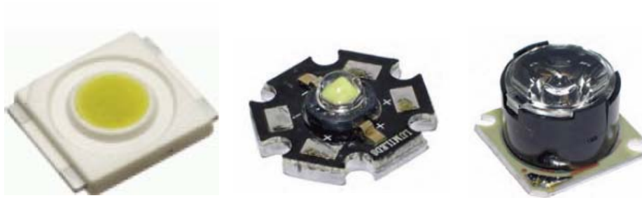
Kuva 2. Teholedejä (1, s. 1; 2, s. 38). Teholedejä ei voi käyttää sellaisenaan (vasen), vaan asennuksessa on oltava mukana jäähdytyslevy (keskellä) ja linssi (oikealla).
