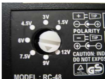
Kuva 1. Jännitteen säätäminen virtalähteen takaa.
