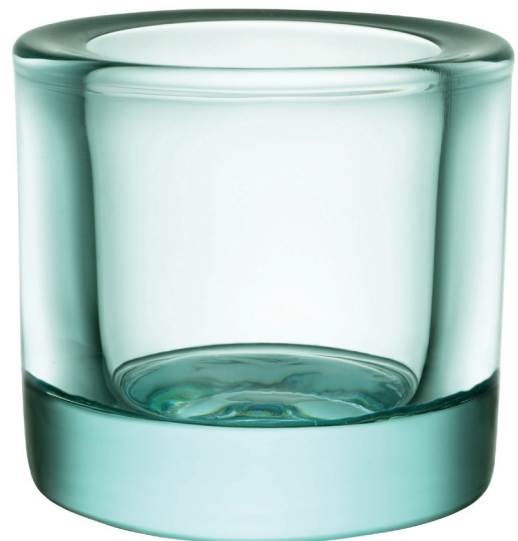
Kuva 8. Puristelasisista esimerkkinä Heikki Orvolan Kivi 60 mm vedenvihreä. Puristelasisissa lasi prässäetään muotoonsa muotin (tuotteen muoto), ja ringin (reunan muovaus) ja painimen (tuotteen sisämuoto) avulla. Tuotteen muotoilusta riippuen itse muotti voi muodostua useammasta osasta, joka avautuu, kun tuote siirretään pois muotista.
