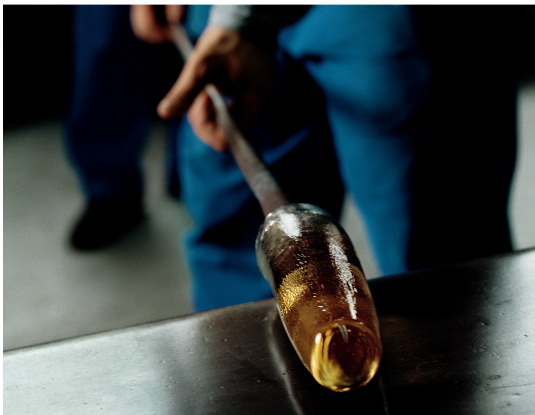
Kuva 42. Kuvassa Veninin lasinpuhaltaja tekee aloitusta, jossa yhdistetty lasiin lehtikultaa.
