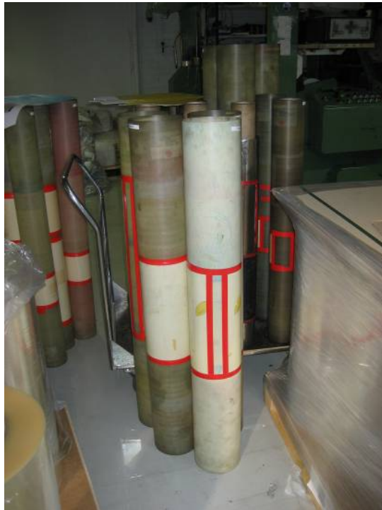
Kuva 3. Paino-osaston lasikuituiset kuvalaattaputket.
